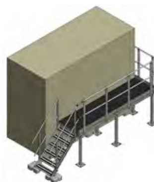
Plateforme scellée au sol
