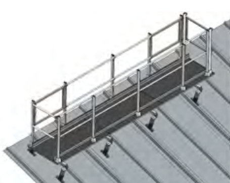
Passerelle sur toiture zinc volige
